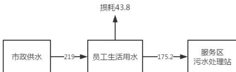
图 2.7 项目水平衡图 (m 3 /a)
