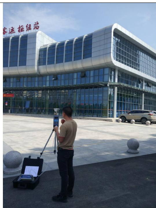
G2 客运枢纽站无组织 下风向监控点 (2019.7.11)
