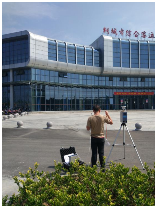
G4 客运枢纽站无组织 下风向监控点 (2019.7.11)
