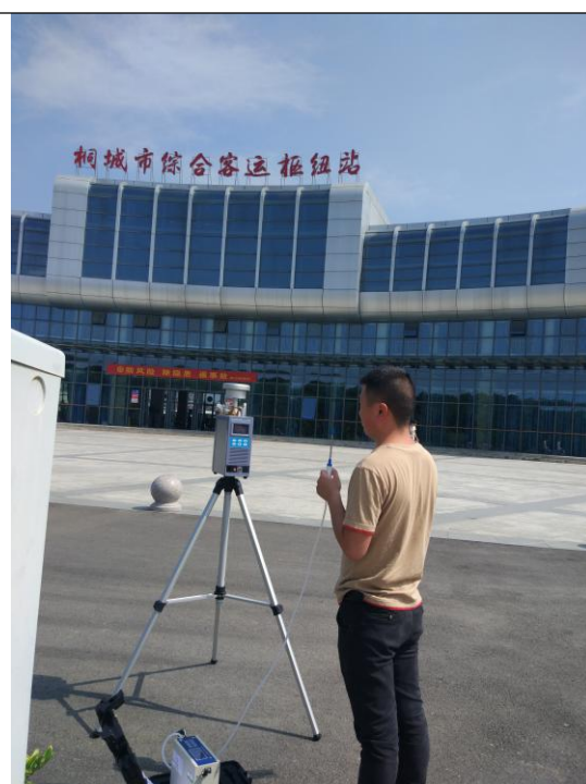
G3 客运枢纽站无组织 下风向监控点 (2019.7.11)
