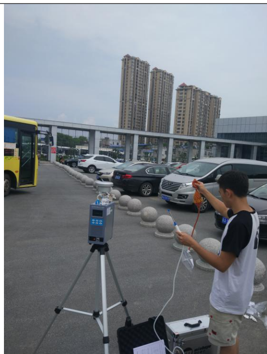
G4 客运枢纽站无组织 下风向监控点 (2019.7.10)
