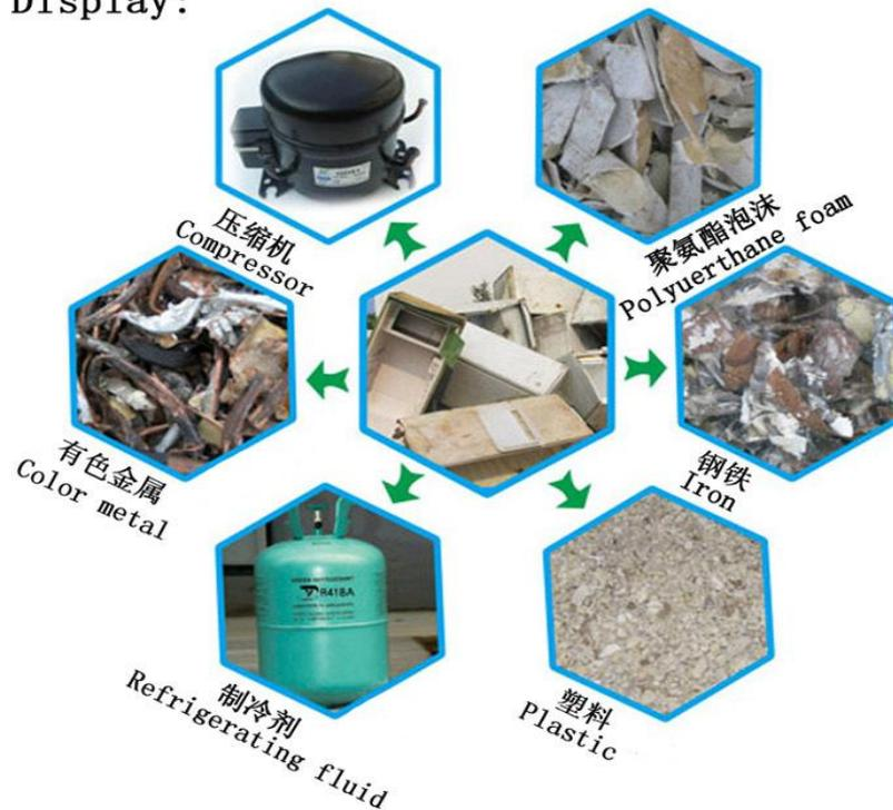
图 3-11 冰箱拆解产物图解
