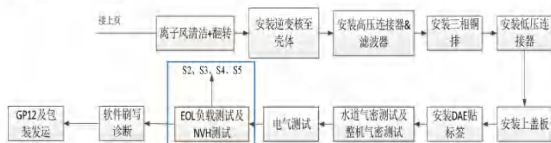
图 2-3 电驱组装工艺流程图（蓝色部分涉及工艺调整、产排污增加）
