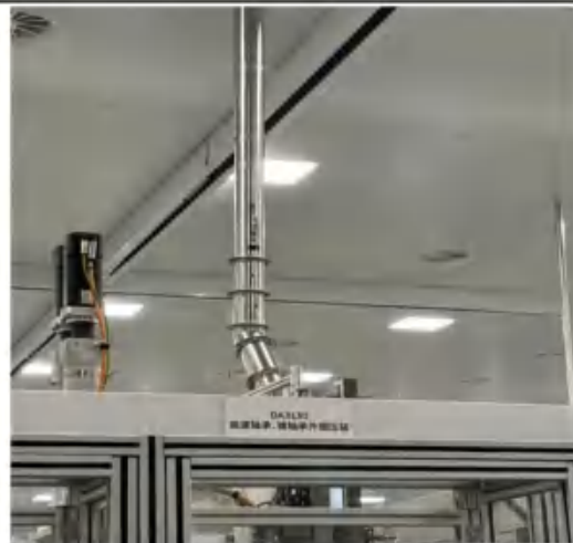
压装主壳体中间轴锥轴承外圈工序（高速轴承、锥轴承外圈压装）集气罩布设情况
