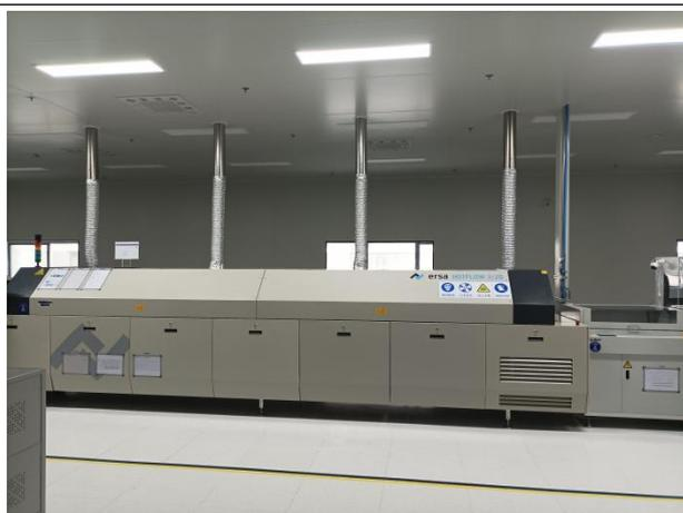
回流焊废气全密闭负压收集
