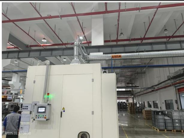
低音炮热板焊接废气集气罩收集
