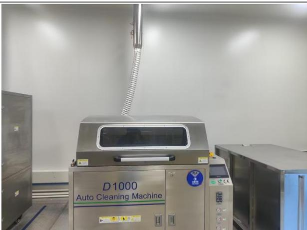
汽车电子钢网清洗废气由设备集气管收集
