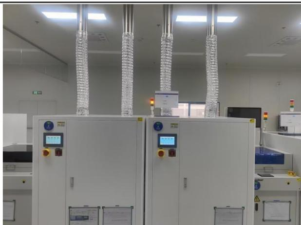
中低音扬声器粘接废气
